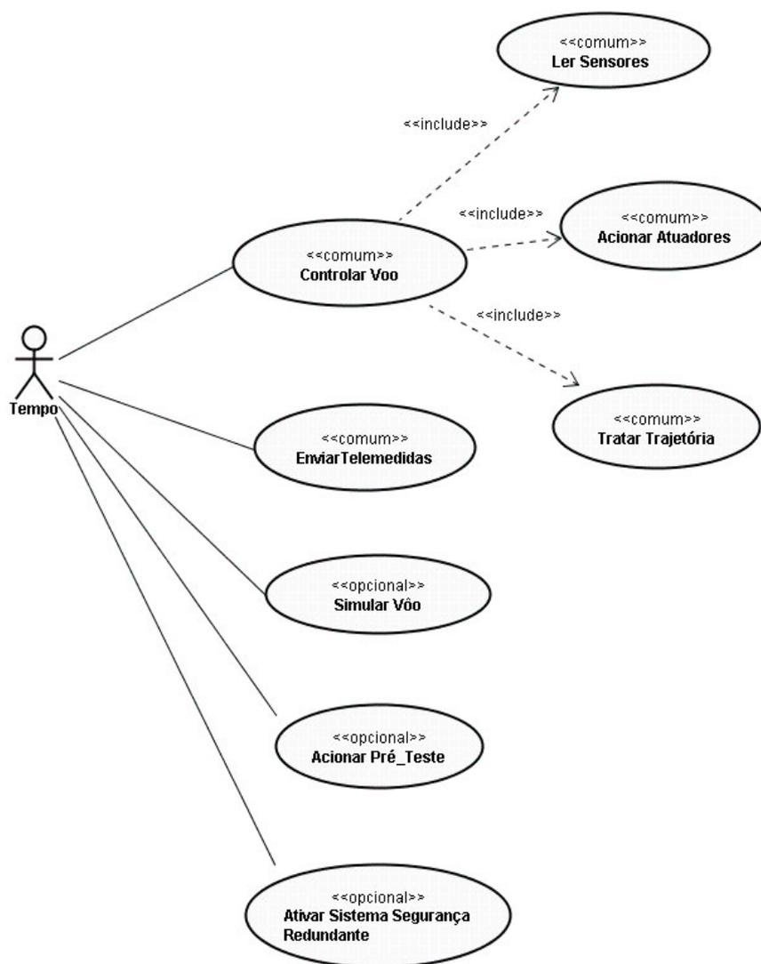
Figura 7.1 - Modelo de caso de uso de linha de produtos de software do veículo LSB
