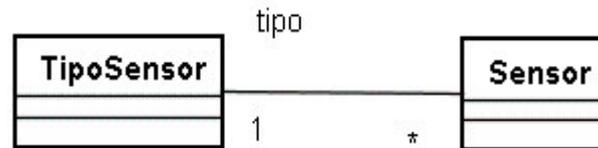
Figura 8.1 - Padrão *TypeObject* para `Sensor` e `TipoSensor`
